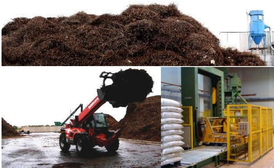
**Figura 14.** (In alto) Stoccaggio delle potature; (In basso a sinistra) Trasporto all'impianto; (In basso a destra) Confezionamento in sacchetti da 15 kg
