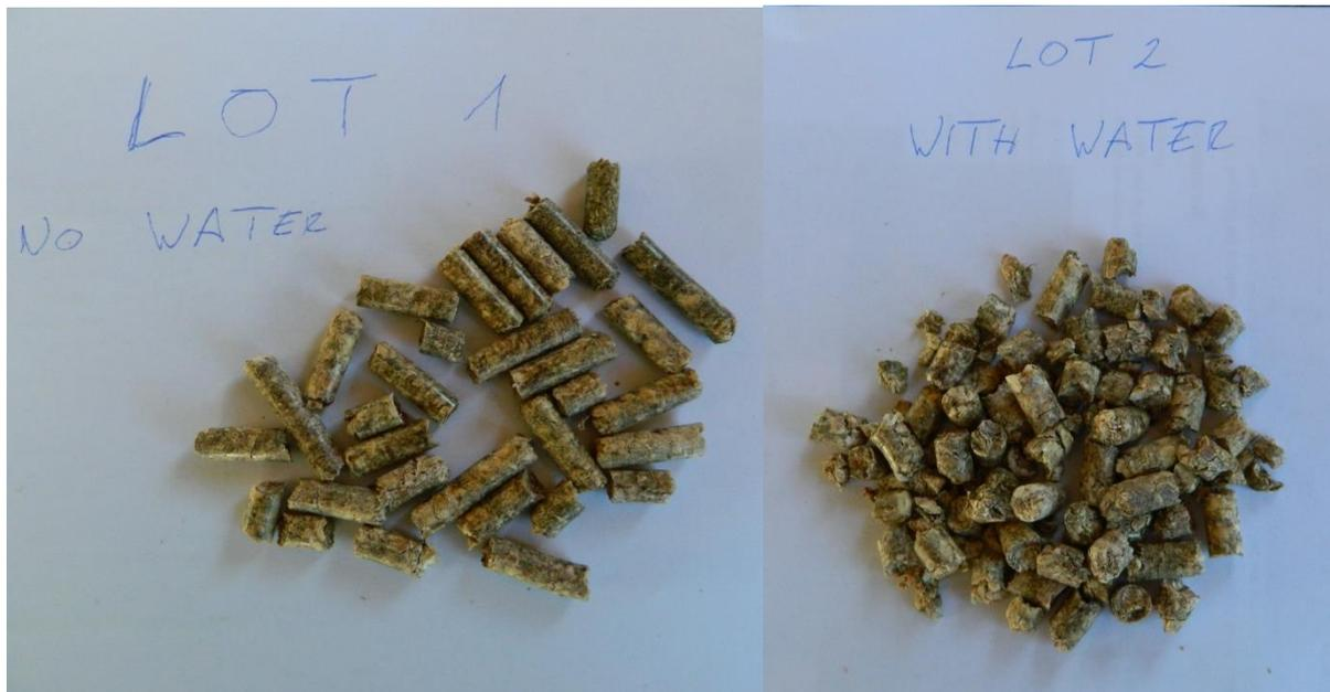
**Abbildung 1: Probe-Pellets, mit und ohne Wasserdampf**
