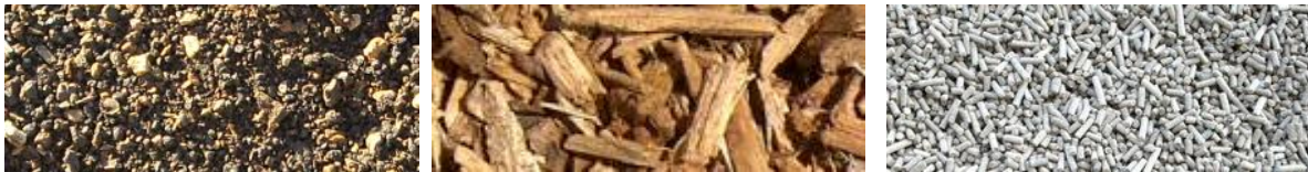
Abbildung 9 : Verschiedene Biomasseformate von Daniel Espuny (von links nach rechts: pulverisierte Oliventrester – Hackschnitzel aus Holzschnitt – pelletierte Oliventrester)
