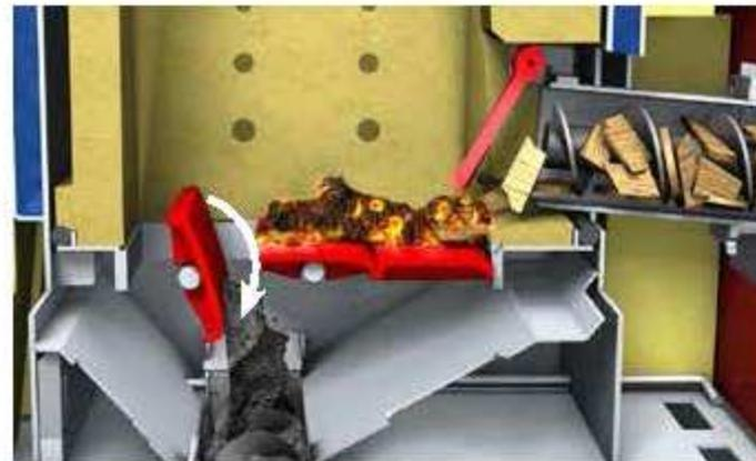
Cuando se utiliza astilla como combustible, durante la eliminación de cenizas solo se abre la **parrilla trasera**. Las cenizas caen abajo, mientras que las brasas residuales
