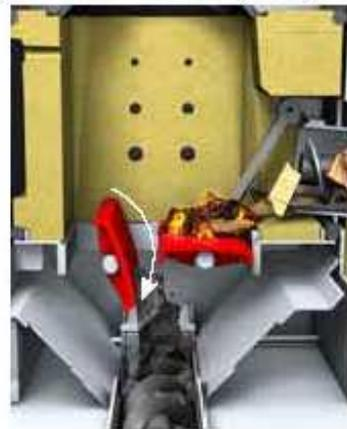
Quando se utiliza astilla como combustible, durante la eliminación de cenizas sólo se **abre la parrilla trasera**. Las cenizas caen abajo, mientras que las brasas residuales permanecen.
