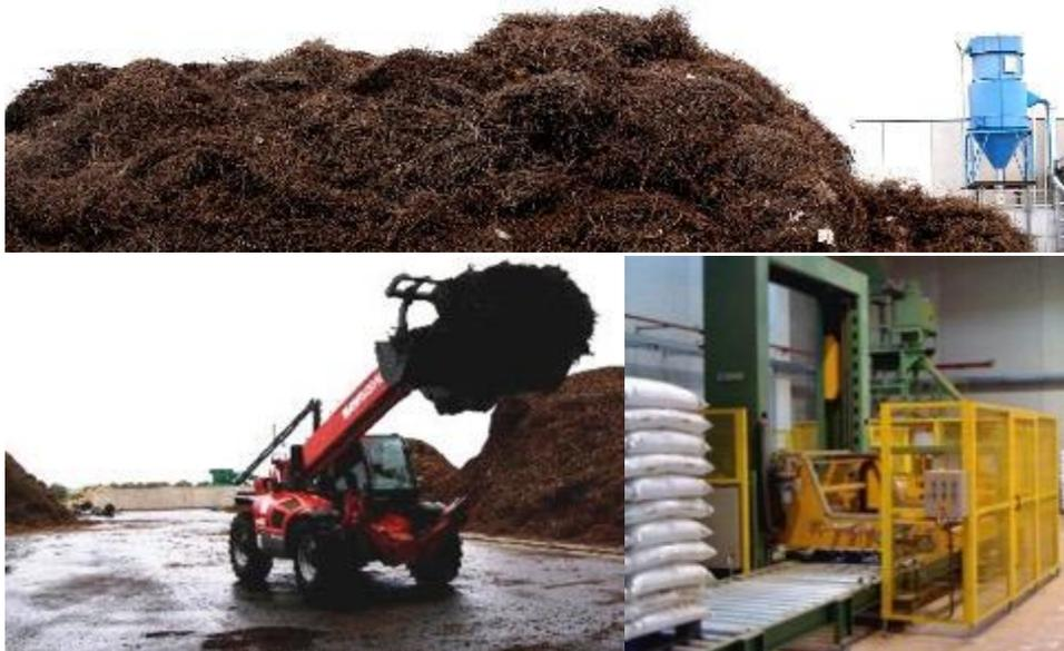
**Abbildung 13.** (Oben) Schnittlager (Links unten) Transport zur Anlage (Rechts unten) 15 kg Bag Befüllungsanlage
