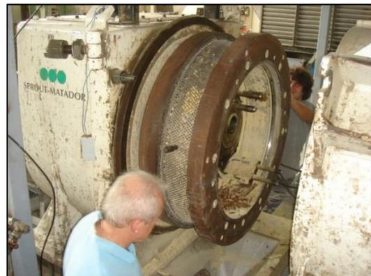
Figura 3: Matriz y peletizadora de Tschiggerl Agrar (Austria).
