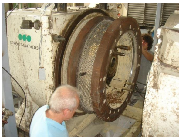
Figura 3: Filiera e pellettatrice di Tschiggerl Agrar (Austria)
