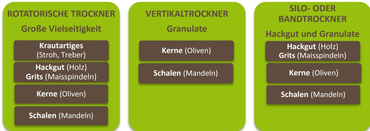
Abbildung 5 : Kompatibilität von Biomasse und Trockner<sup>1</sup>
