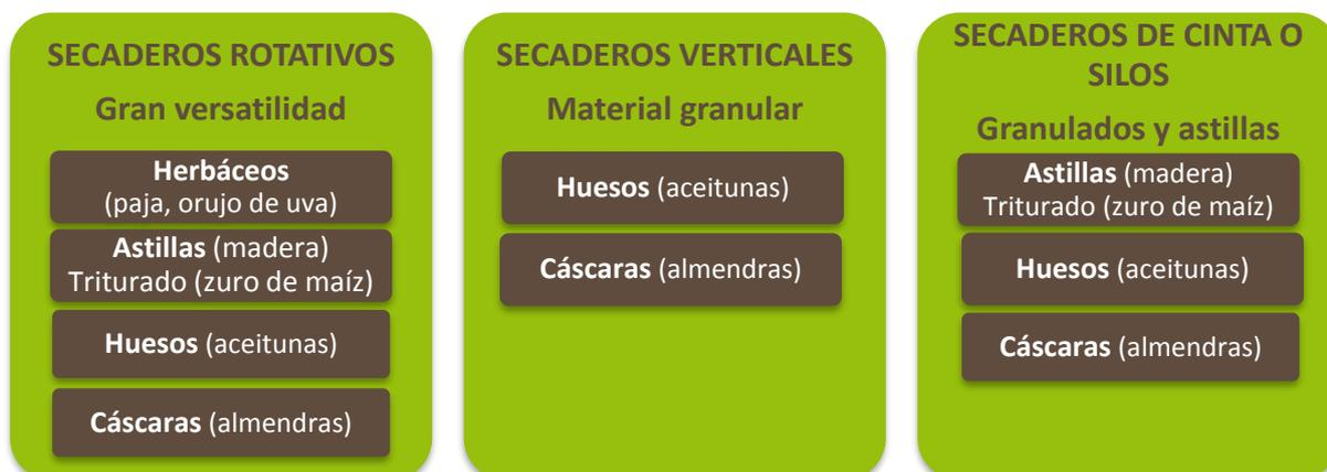
Figura 5 : Compatibilidad de secaderos y biomasa<sup>1</sup>
